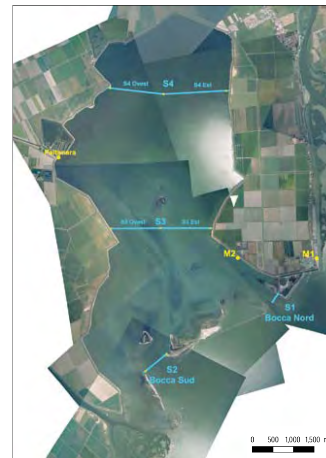
Figura 4: campagne di misura dei parametri idrodinamici: - circolazione delle correnti; - livelli di marea; - portate alle bocche e nei principali canali.
