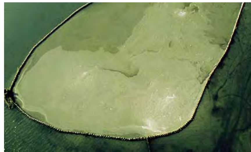
Figura 9: barena artificiale: area perimetrata riempita con materiale di risulta.
