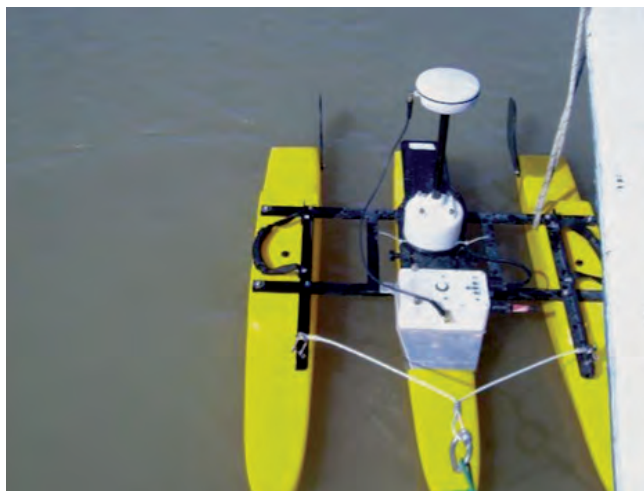
Figura 2a: misuratore ADCP trainato da imbarcazione utilizzato per l'esecuzione delle misure di portata.
