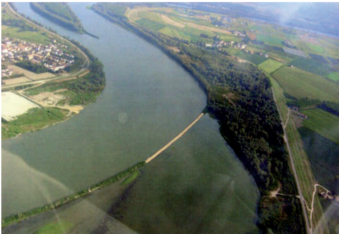
Figura 5: la tendenza evolutiva del Po Grande evidenza una progressiva diminuzione di efficienza a vantaggio, in misura differente, di tutti i rami laterali. Tale comportamento risulta in antitesi rispetto all'effetto atteso in seguito alla realizzazione dei grandi interventi di sistemazione dagli anni '80 ad oggi (drizzaggi ed allargamenti d'alveo). A destra: nuova inalveazione della doppia ansa di Corbola e Bottrighe. A sinistra: drizzagno realizzato in corrispondenza dell'ansa di Volta Vaccari.
